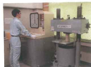
コンクリート圧縮試験 (2000kN圧縮試験機)
