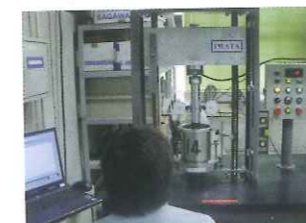
CBR試験 (100kN万能試験機)
