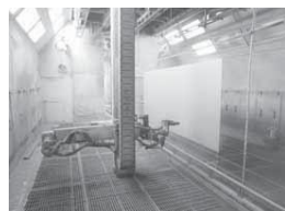
『塗装ロボット』による塗装
