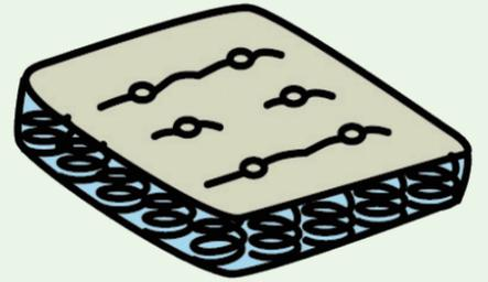
**スプリングの種類**▶ ①コイルスプリング(らせん状の鉄線) ②ポケットコイルスプリング(コイルがひとつずつ袋に入っている) ③Sスプリング(S字状の鋼線) ④ウェビングベルト(ゴムを繊維状に編んだもの)
