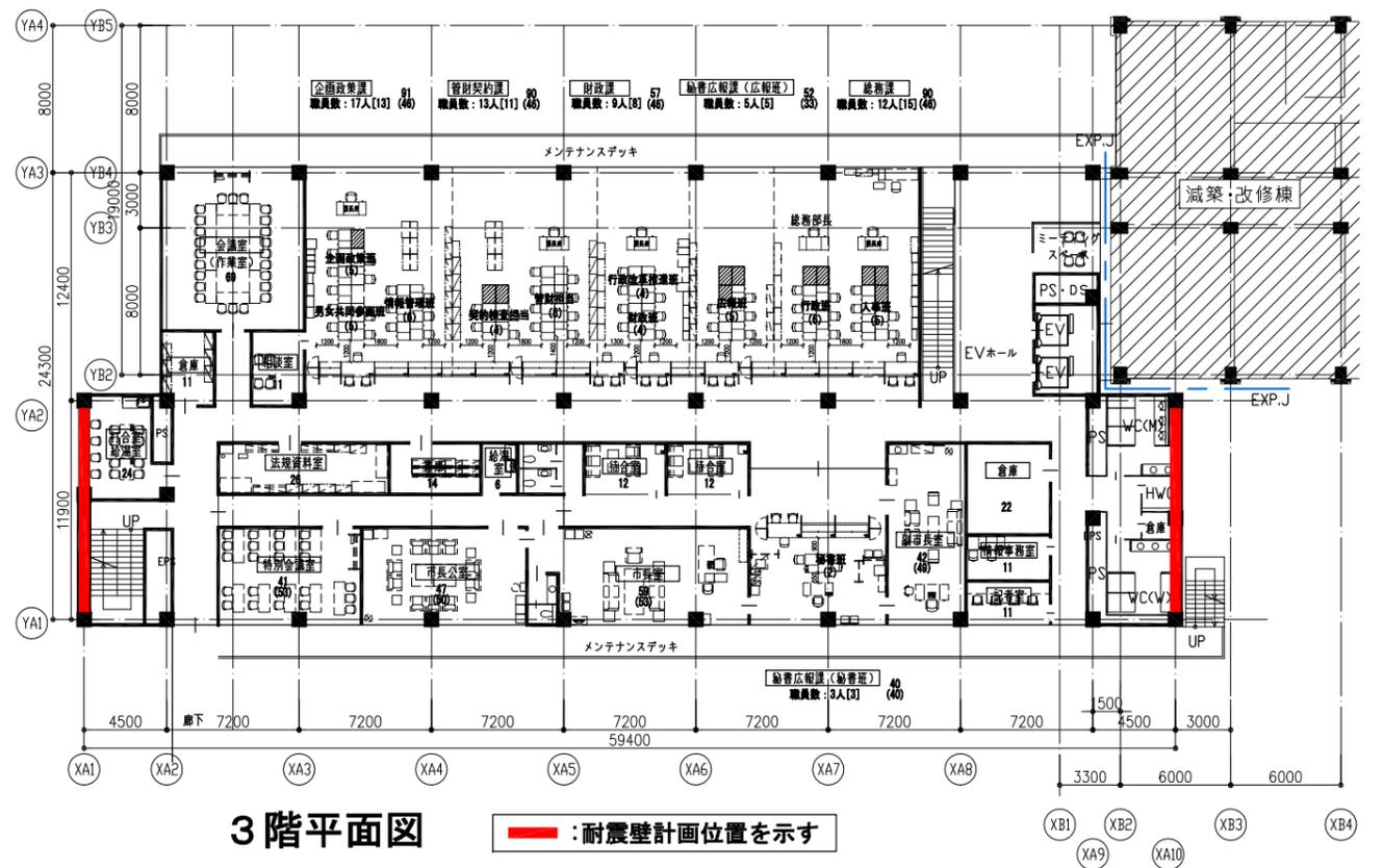
⑥案：S造（XY両方向：ラーメン構造+制震壁）
