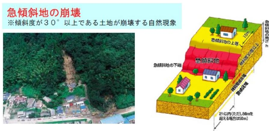
図 2.2-1 土砂災害警戒区域（自然現象の種類：急傾斜地の崩壊）
