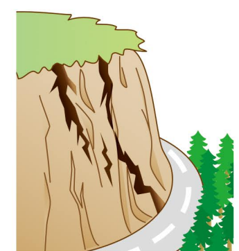
斜面にびび(割れ目)が入る
