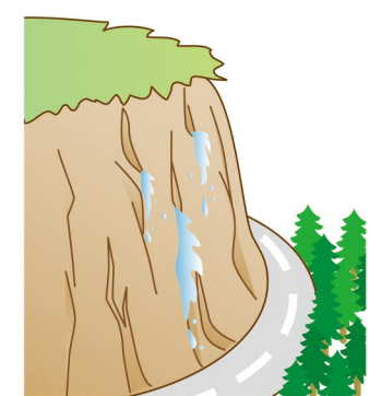
いつもは水が出ていないのに、水が出てくる
