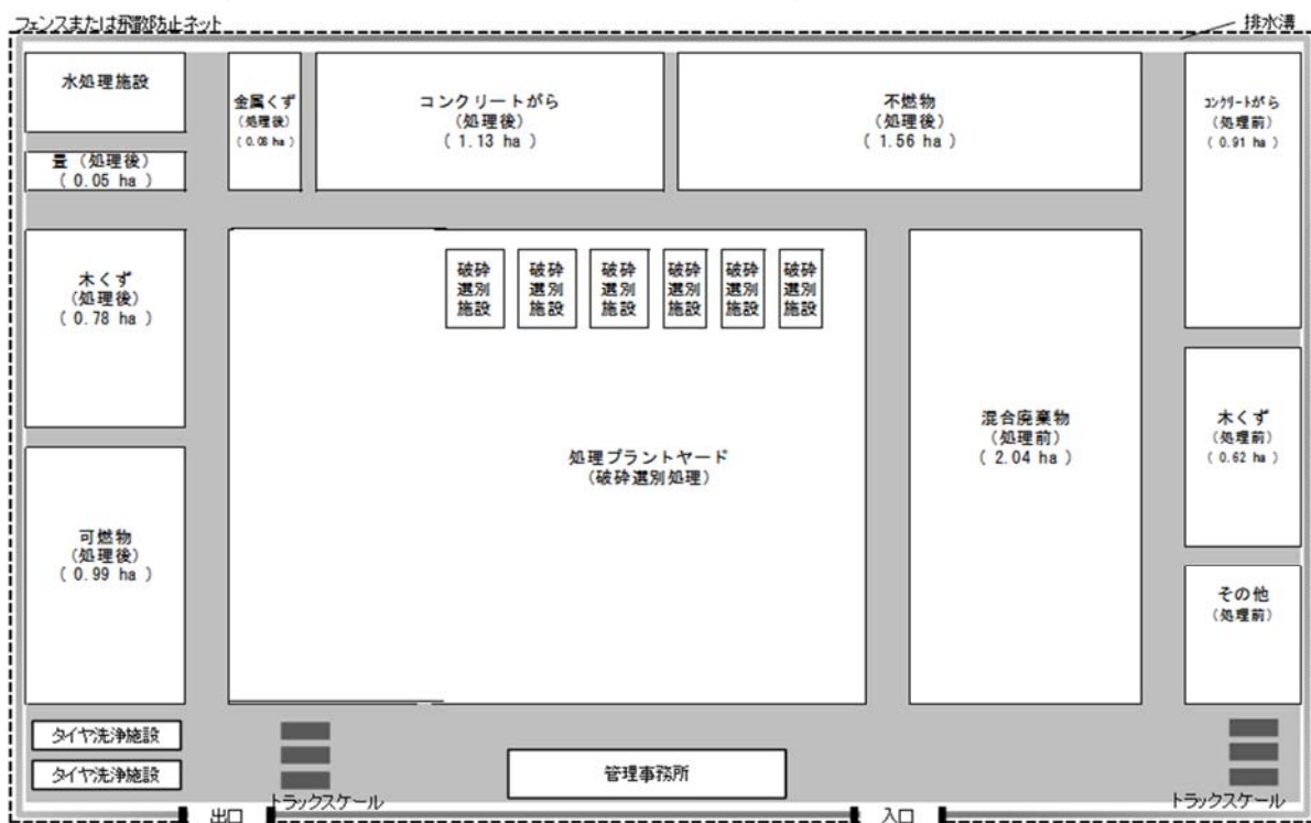
図表 3-2-13 機械選別等を行う二次仮置場のレイアウトイメージ
