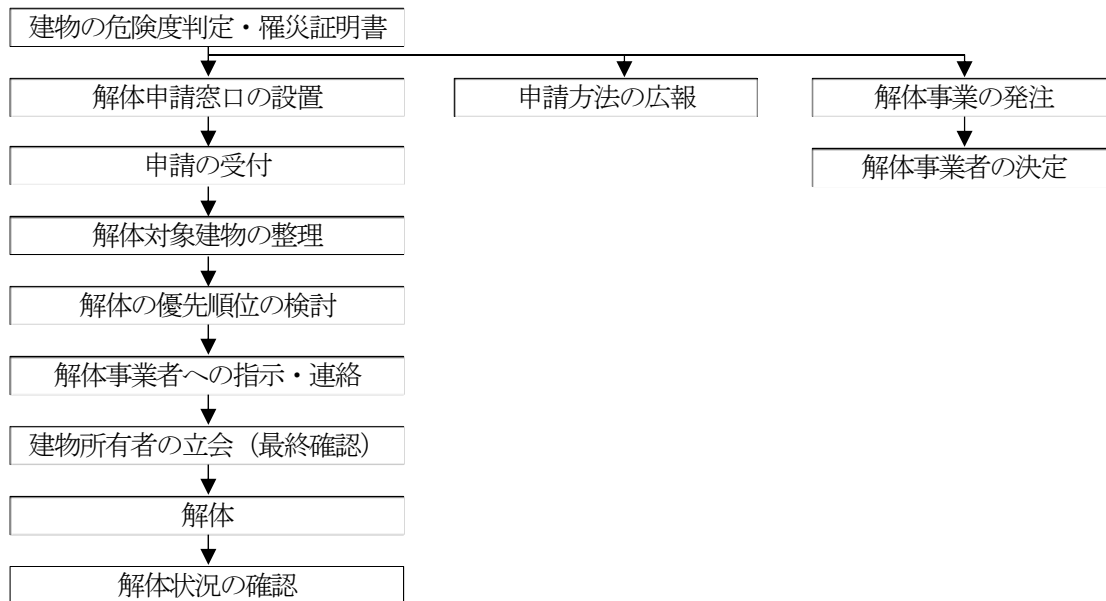
図表 2-2-18 白井市が実施する解体・撤去の手順
