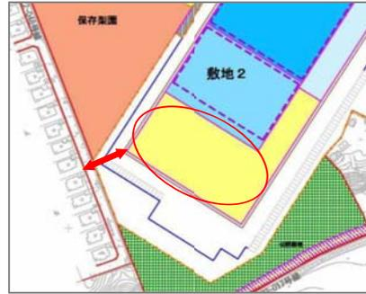
修正例) 最も離隔距離の少なかった「敷地1」を住宅地境界よりセットバック（矢印）目付、建物高さを低減
